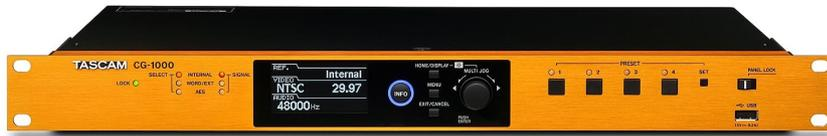
Die Masterclock-Generatoren der CG-Serie basieren auf einem extrem genauen Quarzoszillator mit Jitter-Management und störungsfreier Resynchronisation und gewährleisten dadurch ultrahohe Präzision bei der Taktversorgung. Der CG-2000 ist auf Sende- und Postproduction-Studios ausgerichtet, der CG-1800 für kleine bis mittelgroße Systeme zur Audio/Video-Synchronisation vorgesehen und der CG-1000 für Aufnahmestudios, Livebeschallungen und professionelle Musiker gedacht.
