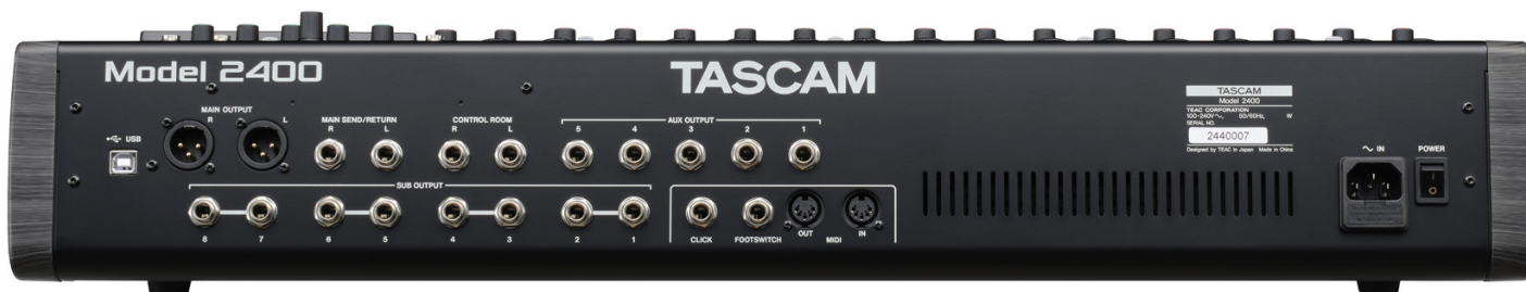
Die Anschlüsse auf der Kopfseite führen diverse Signale aus dem Pult wie etwa die Hauptsomme, die Control-Room-, Click-, Aux- und Subgruppen-Ausgänge. USB- und MIDI-Anschlüsse sowie eine Buchse zum Anschluss eines Fußschalters komplettieren die Ausstattung.
