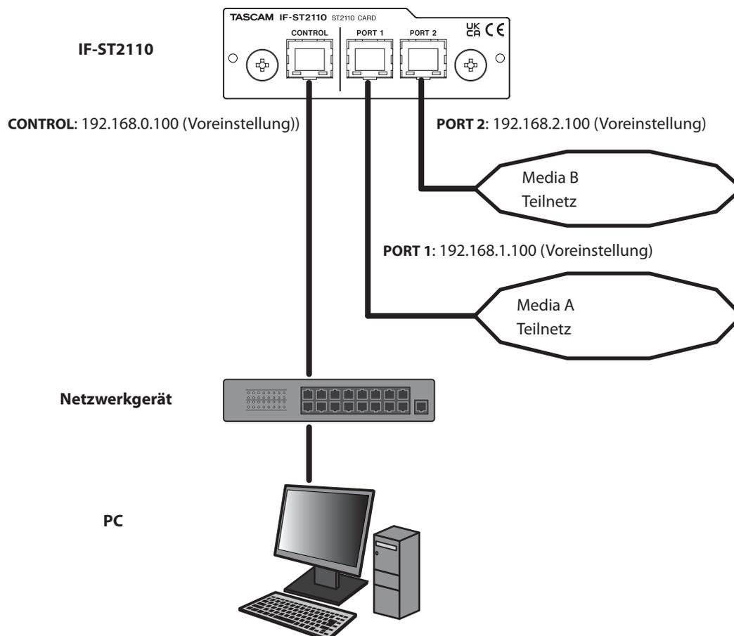
Um auf die WebUI zugreifen zu können, bereiten Sie einen Computer vor und verbinden Sie ihn über ein Netzwerkkabel mit dem Anschluss **CONTROL** der Karte.
