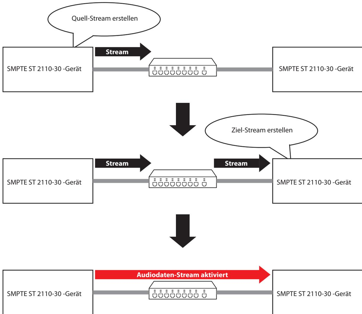
Um einen Ziel-Stream manuell zu erstellen, sind SDP-Daten erforderlich, damit der Datenstrom empfangen werden kann. SDP (Session Description Protocol) ist ein Format, das Parameter für den Aufbau der Übertragung beschreibt.
