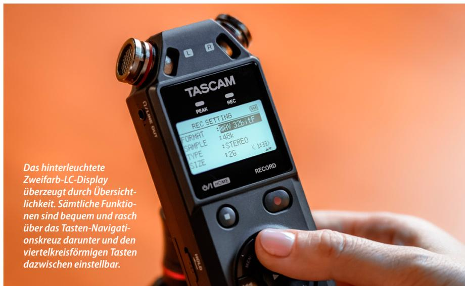
*Das hinterleuchtete Zweifarb-LC-Display überzeugt durch Übersichtlichkeit. Sämtliche Funktionen sind bequem und rasch über das Tasten-Navigationskreuz darunter und den viertelkreisförmigen Tasten dazwischen einstellbar.*
